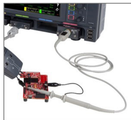
图 32. 使用无源探头进行电压测量的示例。
